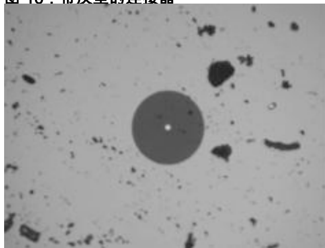
图 17：液体污染连接器
