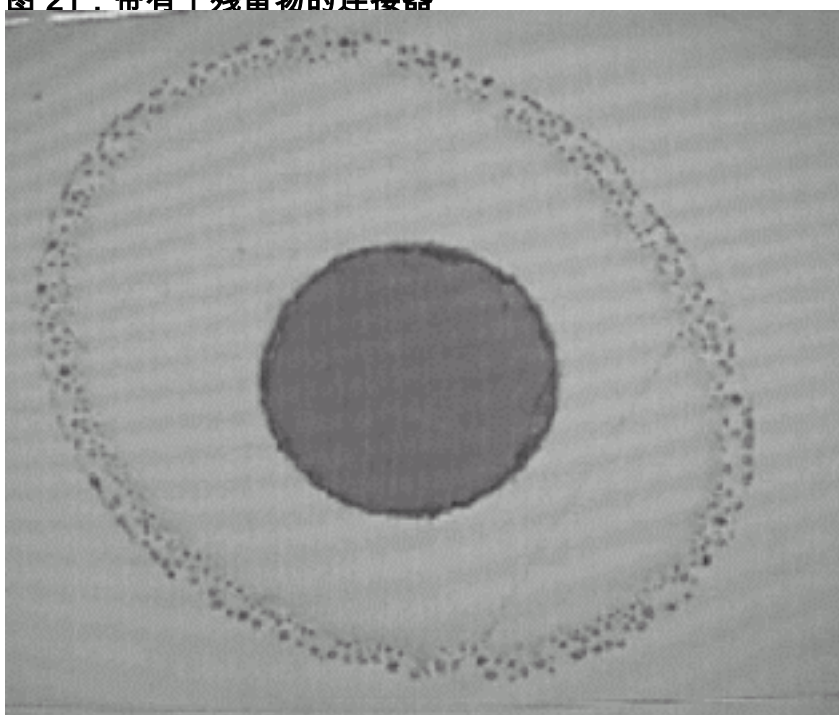
图 22：带有油渣的连接器
