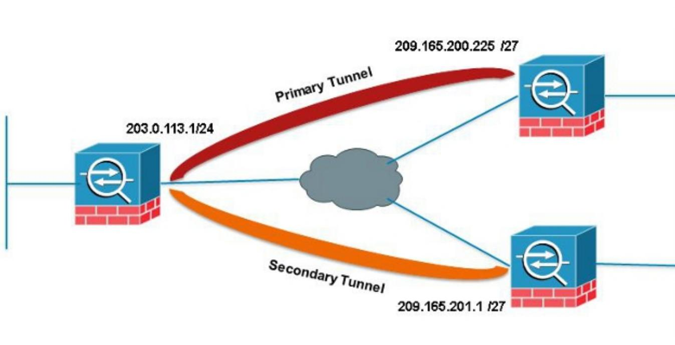
Neste exemplo, uma agregação de nível de local IP (SLA) é usada para monitorar o túnel primário. Se esse peer falhar, o peer de backup assumirá o controle, mas o SLA ainda monitora o principal; quando o Primário voltar, o syslog gerado ativará o EEM para limpar o túnel Secundário, permitindo que o ASA negocie novamente com o Primário.
