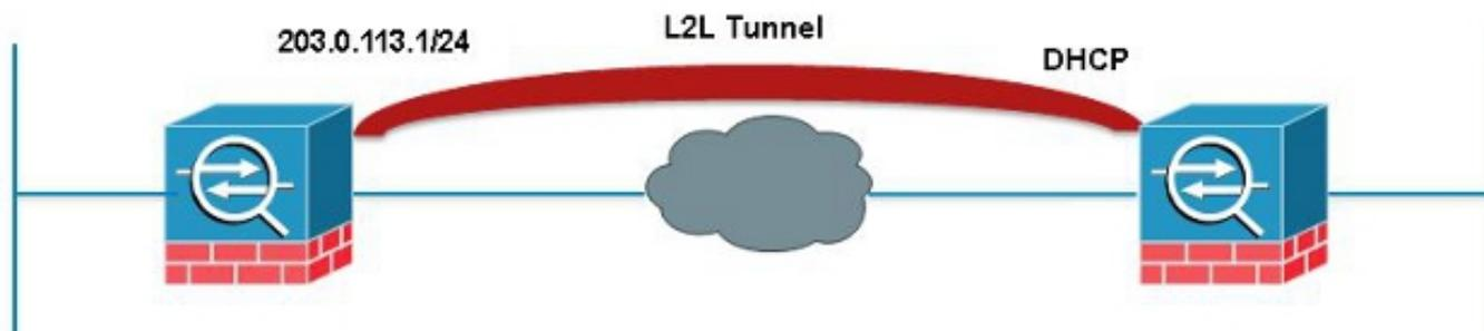
Este EEM enviará um ping a cada 60 segundos através do túnel correspondente ao SA desejado para manter a conexão ativa.
