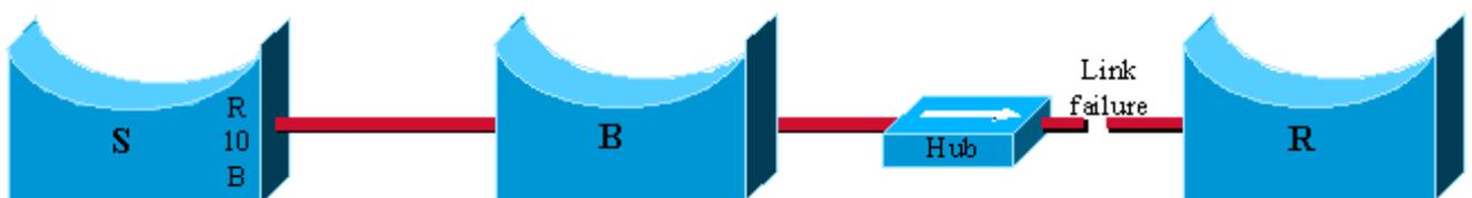
A falha de link ocorre entre a bridge raiz R e o hub. B não detecta que o link fica inativo e aguarda max\_age antes que ele afirme ser a nova raiz. Lembre-se de que o mecanismo só funciona se uma bridge detectar uma falha de link direto.
