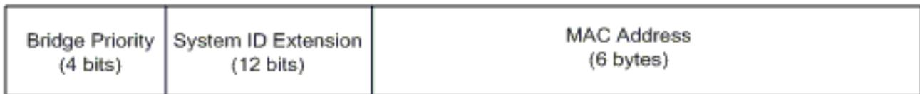
확장 시스템 ID가 확장 범위 VLAN을 활용하기 위해 Catalyst 스위치에서 활성화된 경우 동일한 STP 도메인 내의 모든 스위치에서 활성화해야 합니다. 이는 모든 스위치에서 STP 루트 계산을 일관되게 유지하기 위해 필요합니다. 확장 시스템 ID가 활성화되면 루트 브리지 우선 순위는 4096과 VLAN ID의 배수가 됩니다. 확장 시스템 ID가 없는 스위치는 브리지 ID를 더 세분화하여 선택하므로 실수로 루트를 클레임할 수 있습니다.
