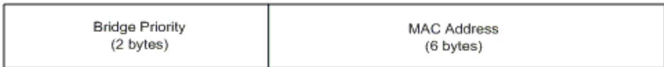
확장 시스템 ID는 BPDU(Bridge Protocol Data Units)의 STP(Spanning Tree Protocol) 브리지 식별자 부분을 수정합니다. 원래 2바이트 우선 순위 필드는 2개의 필드로 분할됩니다. 4비트 브리지 우선 순위 필드 및 VLAN 번호 매기기를 0-4095로 허용하는 12비트 시스템 ID 확장.
