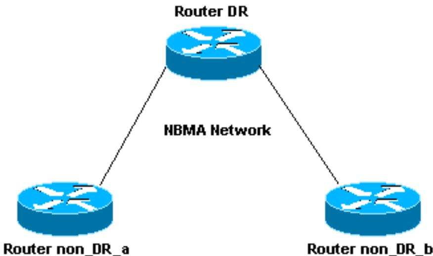
Router non\_DR\_a가 non\_DR\_b 라우터를 통해 경로를 계산하면 Router non\_DR\_b가 다음 홉으로 설정됩니다. 그러나 Router non\_DR\_a에는 Router non\_DR\_b에 대한 가상 회로(VC)가 없으므로 이러한 라우터는 서로 ping할 수 없습니다. OSPF는 연결할 수 없는 next-hop을 사용하여 라우팅 테이블에 경로를 설치합니다.
