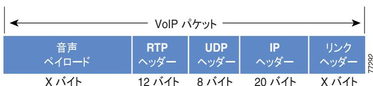
VoIP ストリームによって消費される帯域幅を計算するには、パケットのペイロードとすべてのヘッダーを加算し（ビット単位）、1 秒当たりのパケット レート（デフォルトでは、毎秒 50 パケット）を掛けます。表 3-4 では、デフォルトのパケット レートである毎秒 50 パケット（pps）での VoIP フロー当たりの帯域幅を詳しく記述しています。表 3-4 には、レイヤ 2 ヘッダーのオーバーヘッドは含まれていません。また、Compressed Real-Time Transport Protocol (cRTP) などの可能な圧縮方式を考慮していません。Cisco CallManager Administration の Service Parameters メニューを使用すると、パケット レートを調整できます。
