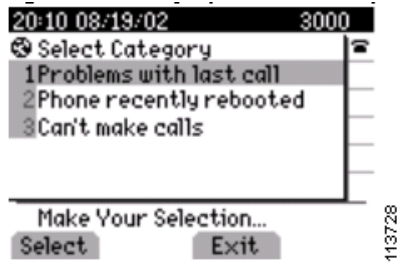
図 38-5 QRT Phone Interface : オンフック、対話モードの表示
