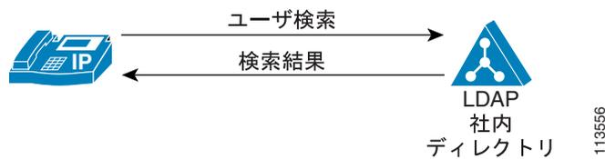
図 20-1 は、この章で定義しているディレクトリ アクセスを示しています。この例では、Cisco Unified IP Phone がアクセスしています。クライアントアプリケーションが、LDAP ディレクトリ（企業の社内ディレクトリなど）に対してユーザ検索を実行し、複数の一致するエントリを受け取ります。その後、Cisco IP Phone ユーザは 1 つのエントリを選択し、そのエントリを使用して、Cisco IP Phone から対応するユーザにダイヤルできます。
