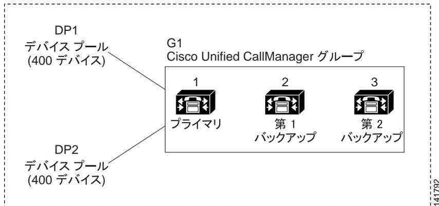
図 7-1 は、2 つのデバイス プール DP1 と DP2 が割り当てられている Cisco Unified Communications Manager グループ G1 を示しています。Cisco Unified Communications Manager 1 は、グループ G1 のプライマリ Cisco Unified Communications Manager であり、通常の動作時には、DP1 と DP2 の 800 台のデバイスをすべて制御しています。Cisco Unified Communications Manager 1 に障害が起きた場合、800 台のデバイスの制御は Cisco Unified Communications Manager 2 に移ります。Cisco Unified Communications Manager 2 にも障害が起きた場合、800 台のデバイスの制御は Cisco Unified Communications Manager 3 に移ります。
