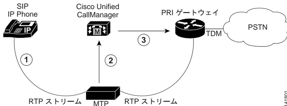
図 41-2 では、メディア ストリーミングから開始し、MTP デバイスは DTMF がダイナミック ペイロードタイプであることを通知されています。
