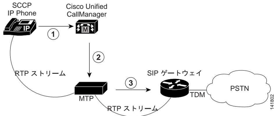
図 41-3 では、メディア ストリーミングから開始し、MTP デバイスには DTMF ダイナミック ペイロード タイプであることが通知されています。
