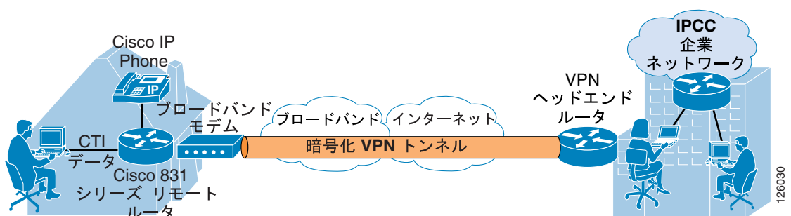
図 2-13 Business Ready Teleworker Solution を介して展開された Unified IP Phone を使用する Unified MA
