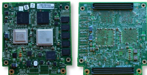
次の図は、拡張ボードを示しています。寸法は、90.17mm x 95.89mm (3.55 インチ x 3.775 インチ) です。
