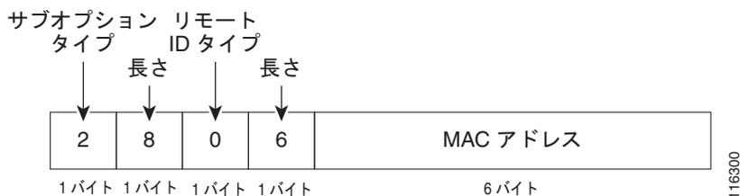
図 26-3 は、ユーザ設定のリモート ID サブオプション、および回線 ID サブオプションのパケット形式を示しています。スイッチでは、DHCP スヌーピングをグローバルにイネーブルにし、**ip dhcp snooping information option format remote-id** グローバル コンフィギュレーション コマンド、および **ip dhcp snooping vlan information option format-type circuit-id string** インターフェイス コンフィギュレーション コマンドを入力した場合に、これらのパケットが使用されます。
