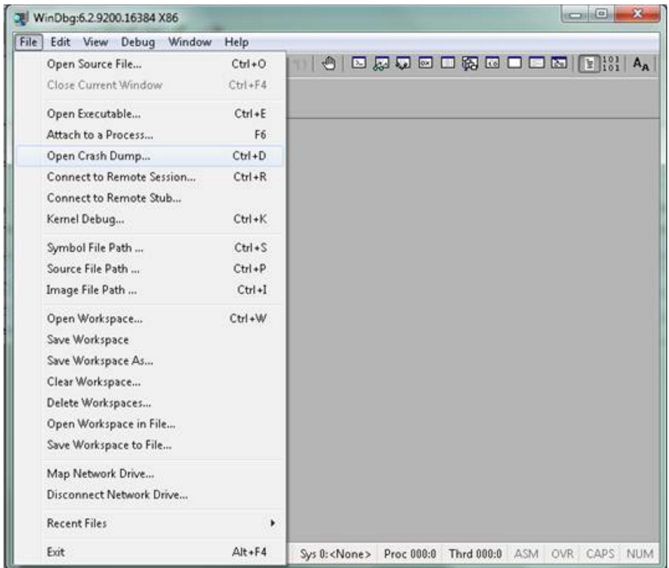
4. .dmp ( memory.dmp、user.dmp など ) ファイルを選択して [Open] をクリックするか、.dmp ファイルを WinDbg にドラッグ アンド ドロップします。この例では、 fulldump ファイルを使用します。
