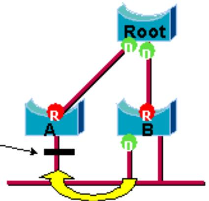
バックアップ ポートとは、そのポートがある同じブリッジから、より有用な BPDU を受信することによってブロックされているポートのことです。次の図に例を示します。
