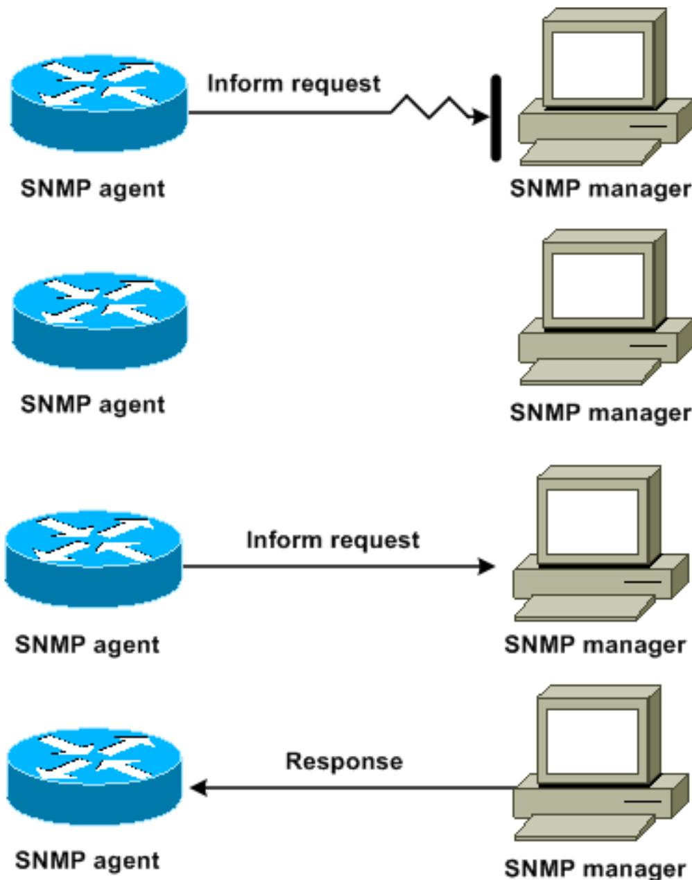
上のダイアグラムは、エージェントからマネージャにインフォーム要求が送信されましたが、インフォーム要求がマネージャに到達しなかったことを示しています。マネージャがインフォーム要求を受信しなかったため、応答は返されません。一定期間が過ぎると、エージェントはインフォーム要求を再送信します。2回目には、マネージャがインフォーム要求を受け取ったので、応答が送信されます。この例では、トラフィックがさらに多くなっています。ただし、通知は SNMP マネージャに到達しています。
