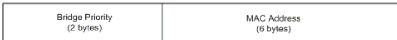
拡張システム ID では、Bridge Protocol Data Unit (BPDU; ブリッジ プロトコル データ ユニット) の Spanning Tree Protocol (STP; スパニング ツリー プロトコル) ブリッジ ID の部分が変更されます。元の 2 バイトのプライオリティフィールドは 2 つのフィールドに分割されます。4 ビットのブリッジプライオリティフィールドと、0 ~ 4095 の VLAN 番号を許可する 12 ビットのシステム ID 拡張。
