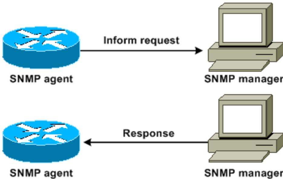
上のダイアグラムは、エージェント ルータからマネージャにインフォーム要求が正しく送信されたことを示しています。マネージャはインフォーム要求を受信すると、エージェントに応答を返します。そのため、エージェント側では、インフォーム要求が宛先に到達したことを認識できます。この例では、トラフィックが2倍になっていることに注意してください。ただし、エージェント側では、マネージャが通知を受信したことを認識しています。
