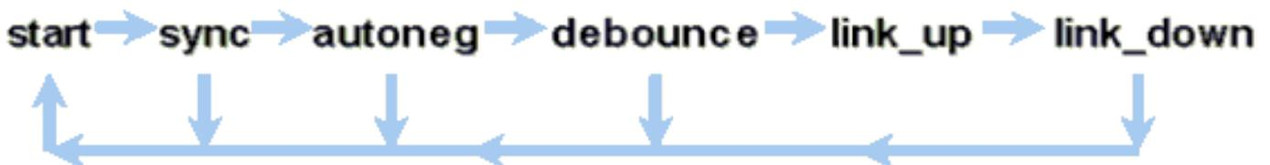
同期の損失とはリンクダウンがMACで検出されることを意味します。同期の損失は自動ネゴシエーションの有効/無効に関係なく適用されます。無効なワードを3回続けて受信するなど、特定の障害条件を満たすと同期が失われます。この状態が10ミリ秒間続くと、sync fail状態がアサートされて、リンクがlink\_down状態に変わります。同期が失われた後に再同期するためには、有効なアイドルが3回連続する必要があります。受信（Rx）信号の損失など、その他の壊滅的なイベントもlink-downイベントの原因となります。
