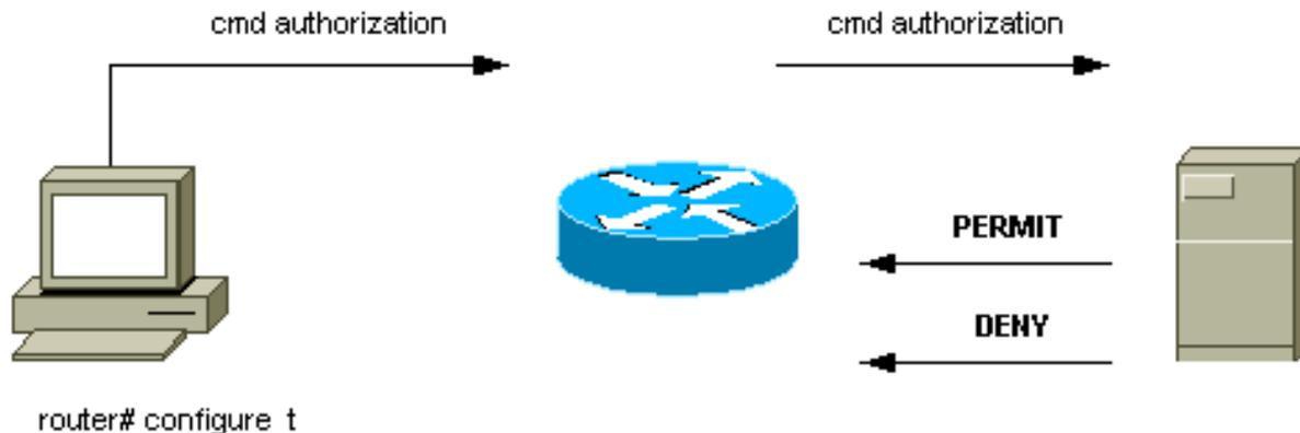
TACACS+ を使用しているネットワーク デバイスに対して、ユーザが単純な ASCII ログインを試みた場合、通常は次の認証プロセスが発生します。
