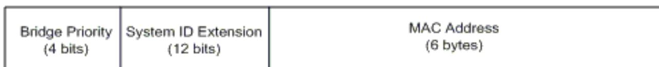
Catalyst スイッチで拡張システム ID をイネーブルにして、拡張範囲 VLAN を利用する場合は、同じ STP ドメイン内のすべてのスイッチで拡張システム ID を有効にする必要があります。この手順は、すべてのスイッチの STP ルート計算の一貫性を保つために必要です。拡張システム ID が有効になると、ルートブリッジのプライオリティは 4096 と VLAN ID の倍数になります。拡張システム ID を持たないスイッチは、ブリッジ ID の選択がより細かく設定されているため、誤ってルートを要求する可能性があります。
