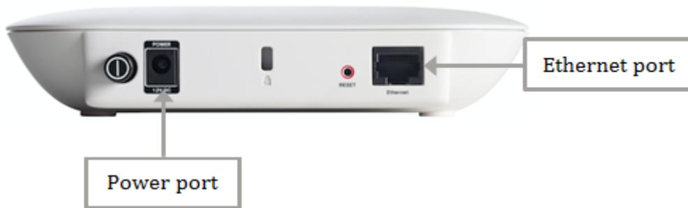
注：WAPがルータまたはスイッチから完全な電源を供給していることを確認するために必要なPoEタイプをメモします。デバイスのドキュメントで、802.3afまたはHigh Power 802.3at PoE規格に対応しているかどうかを確認し、スイッチまたはルータがWAPに対応できるかどうかを確認します。アクセスポイントのPoE電源を確認するには、[ここをクリックします](#)。
