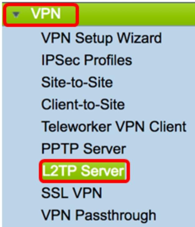
ステップ2:[L2TPサーバ上]ラジオボタンをクリックして、L2TPサーバを有効にします。
