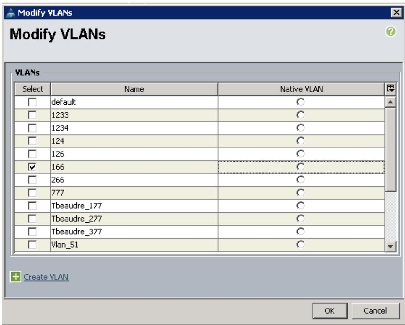
隔離 VLAN のみを追加して、ネイティブとして設定する必要があります。vNIC ごとに許容されるネイティブは 1 つだけです。ここではネイティブ VLAN が定義されていないため、N1K 上のネイティブ VLAN にタグを付けます。ネイティブ VLAN にタグを付けるオプションは VMware DVS では使用できないため、DVS ではサポートされません。
