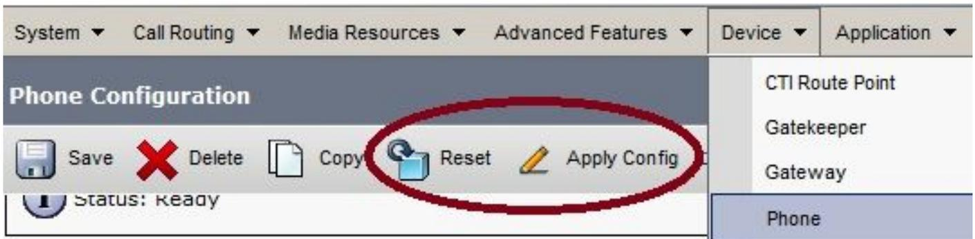
**Note:** Quand le téléphone IP est dans le côté distant, il reçoit normalement une adresse IP d'un serveur DHCP externe. Pour que le téléphone IP reçoive la nouvelle configuration du CUCM, il devrait contacter le serveur TFTP dans le bureau central. Normalement le CUCM est le même serveur TFTP.
