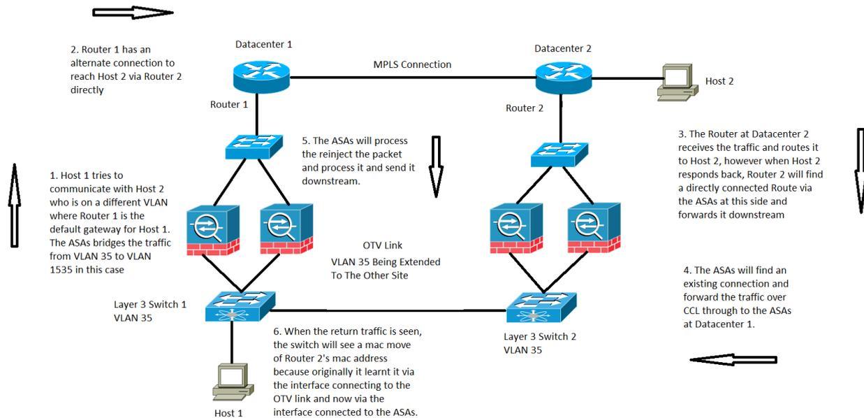
Pour une communication inter-contrôleur de domaine (DC) en mode transparent, ce flux de trafic spécifique n'est pas couvert ou documenté, mais ce flux de trafic spécifique fonctionne d'un point de vue de traitement de flux ASA. Cependant, il peut entraîner des notifications de déplacement MAC sur le commutateur.
