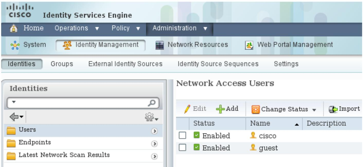
Le nom d'utilisateur **cisco** est utilisé. Configurez MS Windows XP pour le protocole EAP (Extensible Authentication Protocol-Protected EAP) avec ces informations d'identification.
