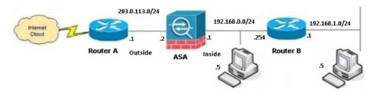
**Note**: Les schémas des adresses IP utilisés dans cette configuration ne peuvent pas être routés légalement sur Internet. Ce sont des <u>adresses RFC 1918</u> qui sont utilisées dans un environnement de laboratoire.
