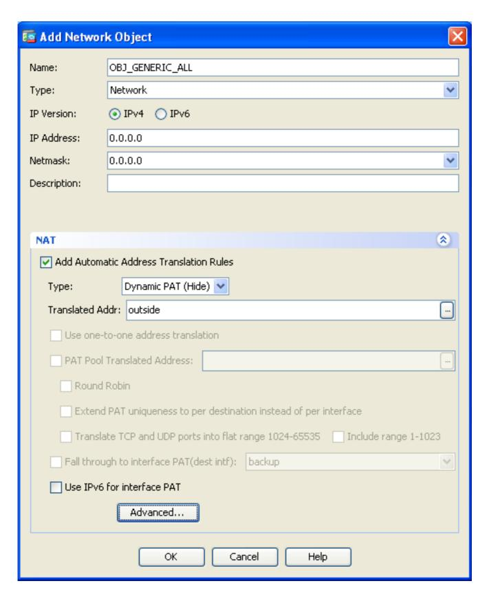
4. Cliquez sur **Avanced** pour sélectionner une interface de source et une interface de destination :
