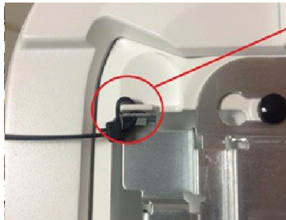
図 5: 天井タイルよりも上部の空間に HyperLocation を取り付けないこと
